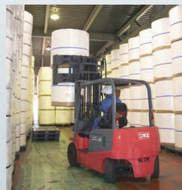
・ローテーティングロールクランプ仕様 「トランサー・フォルセア」
