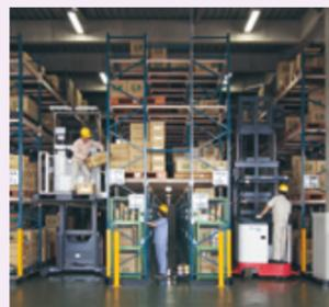
この物流センターは、関西地区の機能強化のために一般倉庫を新設しました。建設にあたっては、より多くの製品を格納できる収容効率、さらに主な配送先である印刷会社さまは在庫を持たないのが一般的なので、きめ細やかな小口配送に対応できるレイアウトをニチュ三菱さんに考えていただきました。倉庫は4階建てですが、1階から3階までは通路幅1,680mmのラック&フォークシステムを導入し収容効率を高めました。ここでは主に、ラックフォークJr.とピッカーエースを使った作業を行います。中でも、一番の特長は1階です。3ヶ所のラックの最下段には内向きにピッキング用のラックを設置。2段目以上はこの2列のラックをつないで外向きの
