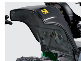
大型発泡充填遮音材をボンネット内側に装備
